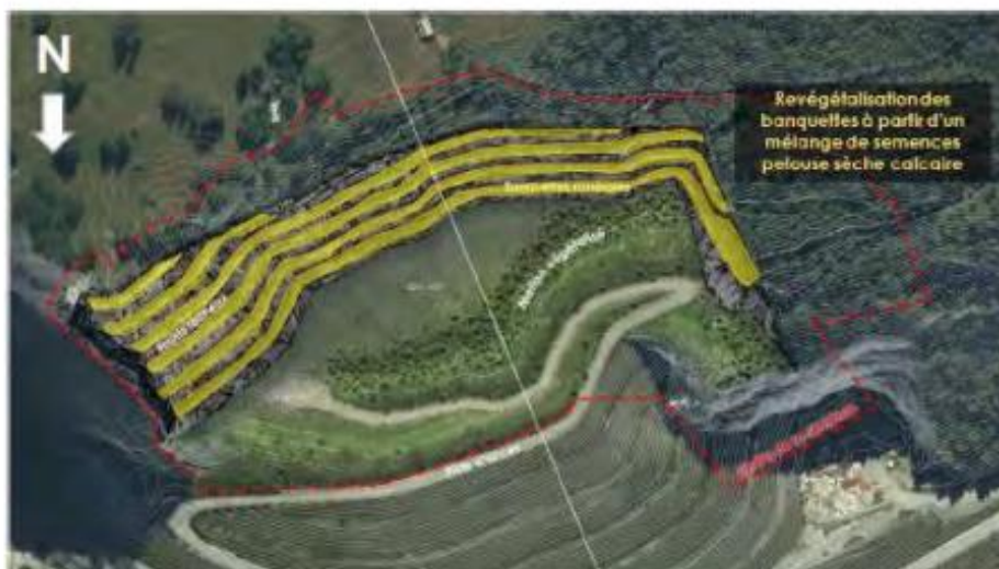
Localisation des banquettes à resemencer – schéma de principe de remise en état Source : KARUM Actions nature
